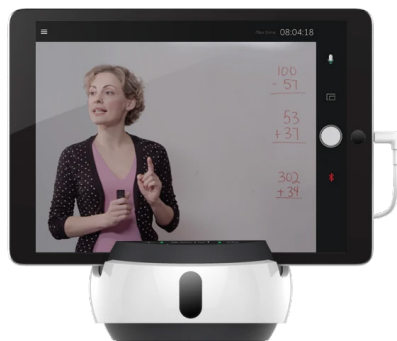
3 pav. Robotizuotas išmaniojo įrenginio stovėlis
